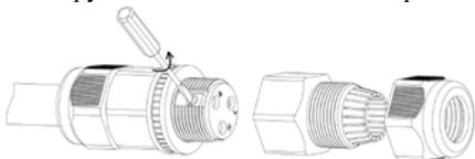
5. Продеть кабель через крышку с зажимной гайкой. Зачищенный провод вставить в отверстие на разъеме так, чтобы только оголенная часть провода оказалась внутри клеммы. Подключение проводов в разъеме производить строго в соответствии с обозначением на торцевой поверхности центральной части коннектора. Закрепить провода в клеммах закрутив винты клемм.
