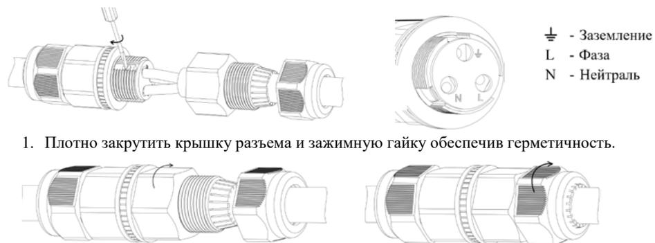
1. Плотно закрутить крышку разъема и зажимную гайку обеспечив герметичность.
