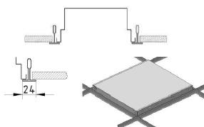
3.2. Установка в підшивні стелі. Для установки світильника в підшивні стелі з гіпсокартону необхідно замовити комплект кліпс. Код замовлення кліпс - 2905000110 (4 штуки), (де а - настановний гвинт, б - лапка монтажна).
