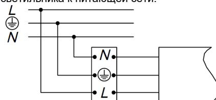
2. Схема подключения светильника к питающей сети с блоком резервного питания (на рис. а - блок резервного питания).
