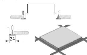
3.2. Установка в подшивной потолок. Для установки светильника в подшивные потолки из гипсокартона необходимо заказать комплект клипс. Код заказа клипс — 2905000110 (4 штуки), (где а - установочный винт, б - лапка монтажная).
