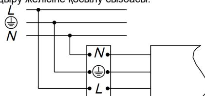
2. Резервтік қуаттандыру блогы бар қуаттандыру желісіне қосу сұлбасы : (сур. а - Резервтік қуаттандыру блогы).
