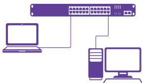
Соедините порт коммутатора с сетевой картой ПК, подключите питание к коммутатору. Настройте на сетевой карте ПК IP-адрес из диапазона 192.168.1.2-254, например 192.168.1.100. Откройте WEB-браузер и введите адрес <http://192.168.1.1> для доступа к WEB-интерфейсу, либо подключитесь к IP 192.168.1.1 по протоколу Telnet.
