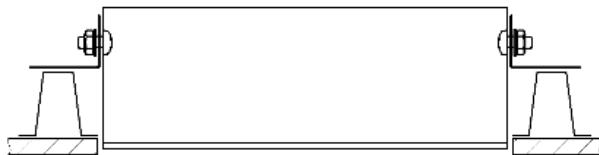
3.4. Для облегчения обслуживания светильника рекомендуется дополнительно закреплять монтажные пластины на траверс винтами саморезами, при необходимости, просверлив в гребенке (траверсе) отверстия требуемого диаметра (а - реечная панель, б - траверса, с - монтажная пластина, д - винт, е - шайба, ф - гайка, г - дополнительное место крепления).
