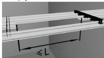
3.3. Установить светильник на направляющие шины реечного потолка и отрегулировать высоту кронштейнов таким образом, чтобы положение светильника совпало с положением рейки.
