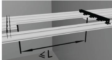
3.3. Шырақты кескіш төбенің бағыттаушы шиналарына орнатыңыз және кронштейндердің биіктігін шырақтың қалпы рейканың жағдайына сәйкес болатындағы етіп реттеңіз.
