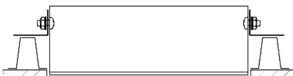
3.4. Шыраққа қызмет көрсетуді жеңілдету үшін траверске монтаждық пластиналарды өзекшелермен қосымша бекіту ұзынлылады, қажет болған жағдайда, талап етілетін диаметрдегі тесікті тарақта (траверсте) бұрғылап тесу ұзынлыады (а -тақтайшалы панель, b - траверса, c - монтаждық пластина, d - бұранда, e - тығырық, f - сомын, g - қосымша бекіту орны).
