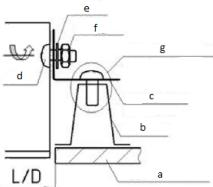
3.5. Подключить сетевой провод к клеммной колодке в соответствии с указанной полярностью. При использовании регулируемого ЭПРА, управляющие провода подключаются строго с соблюдением полярности, указанной в маркировке (для ЭПРА DALI полярность безразлична).
