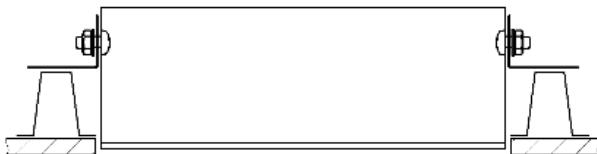
3.4. Для полегшення обслуговування світильника рекомендується додатково закріплювати монтажні пластиини на траверс гвинтами саморізами, при необхідності, просвердливши в гребінці (траверсі) отвори необхідного діаметра (а - рейкова панель, б - траверс, з - монтажна пластина, д - гвинт, е - шайба, ф - гайка, г - додаткове місце кріплення).
