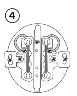
Установить механизм изделия в углубление стены, зафиксировать стопорные и крепежные винты на корпусе изделия, затянув их до упора. Install the mechanism into the hollow in the wall, tighten firmly the locking and the fastening screws on the unit housing.
